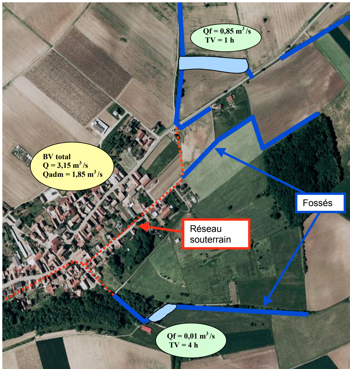
Figure 19 : Le réseau d'assainissement pluvial avec débits de fuite et temps de vidange de chaque bassin
