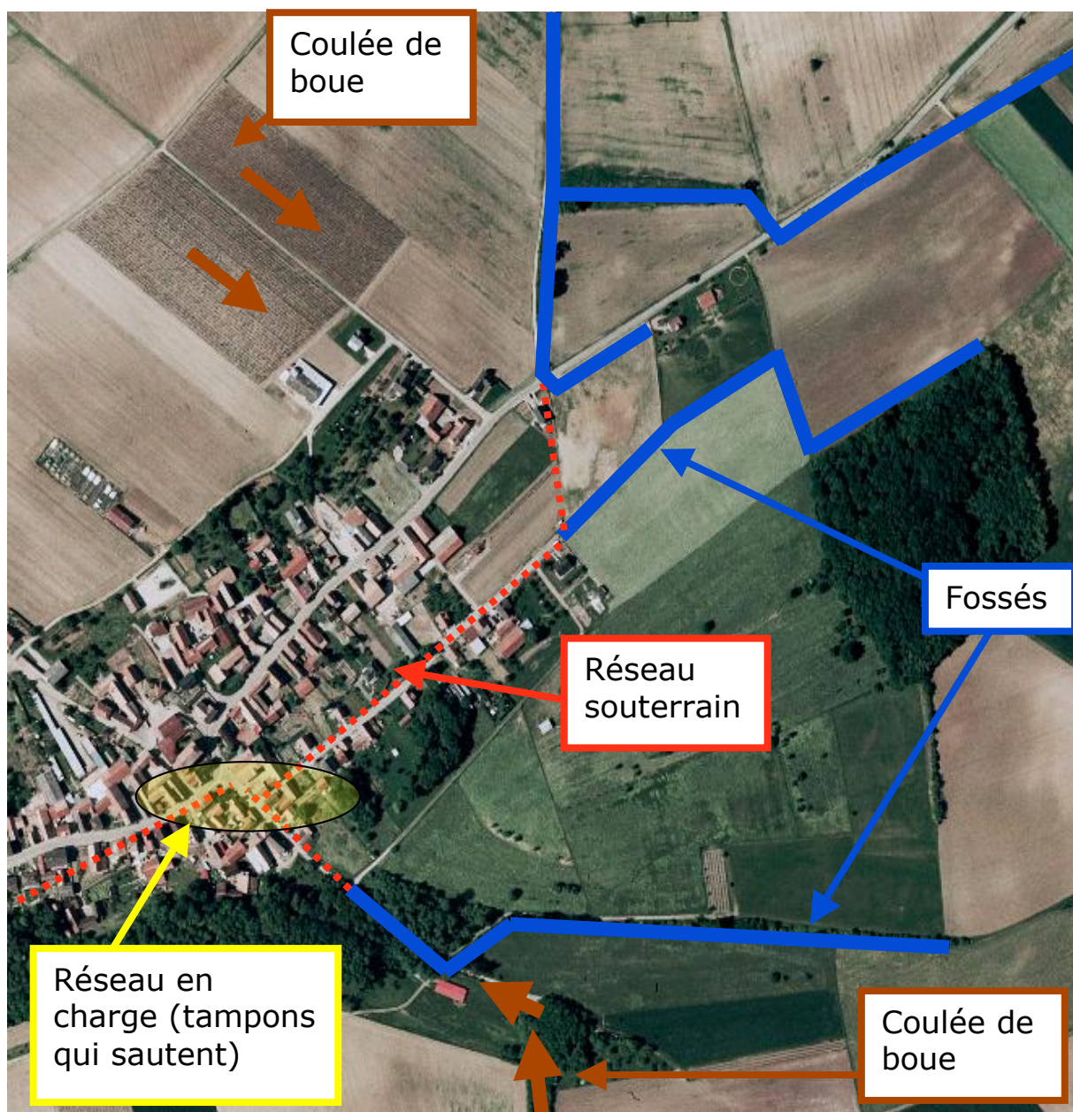
Figure 7 : Photo aérienne schéma de fonctionnement hydraulique
